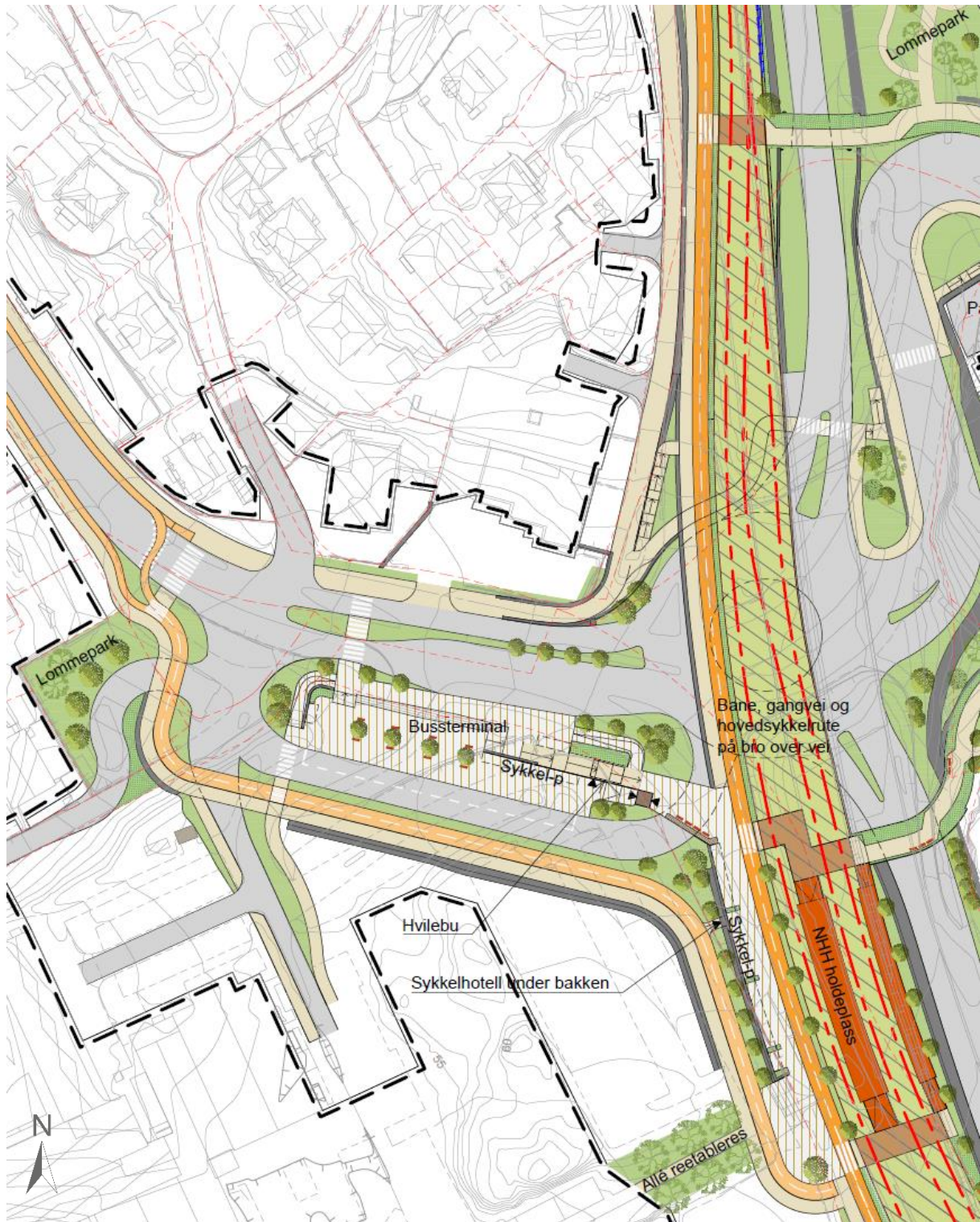
Tegnforklaring Bybaneplattform Vann Banespor Fortau / gangareal Naturområde / reetablering Gress i banespor Hovedsykkelveg Park / grøntområde Banetrasé i tunnel Sykkelveg /-felt Mur / konstruksjon /skjæring Senterlinje spor Kjøreveg Møblering Trær / annen vegetasjon Torg / plassdannelse Nye bygg / byggeområde Støyskjerm Takoverbygg Tunnelmunning
