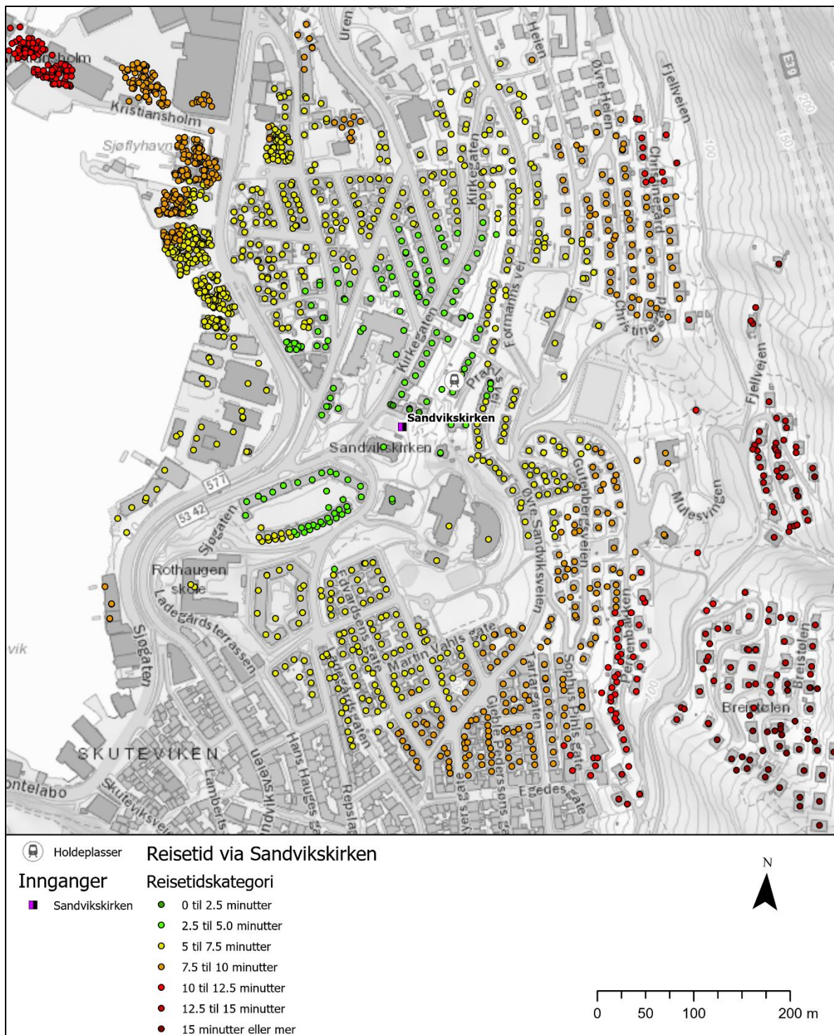
Figur 7-14: Gangtid fra adresser til den underjordiske perrongen, ved alternativ med én publikumsinngang ved Sandvikskirken.
