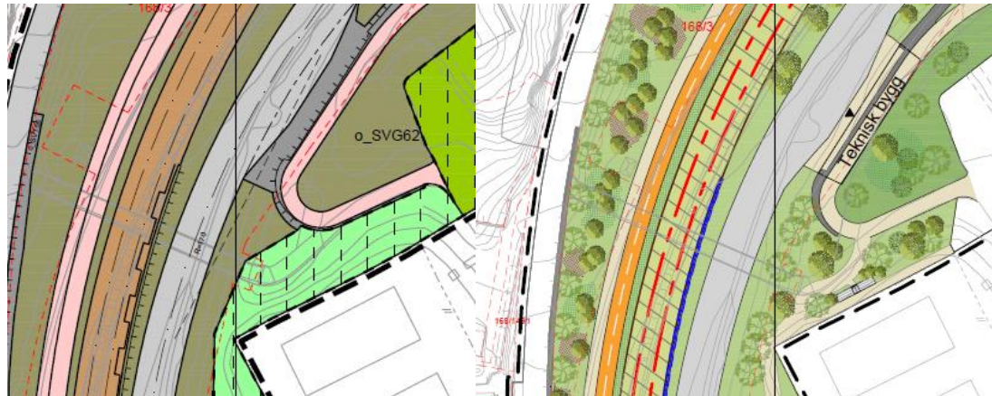
Figur 6-53: Utsnitt fra plankart (til venstre) og fra illustrasjonsplan (til høyre) som viser banen sør for Eidsvåggtunnelen. Illustrasjonsplanen viser at dekket skal være grønt.
