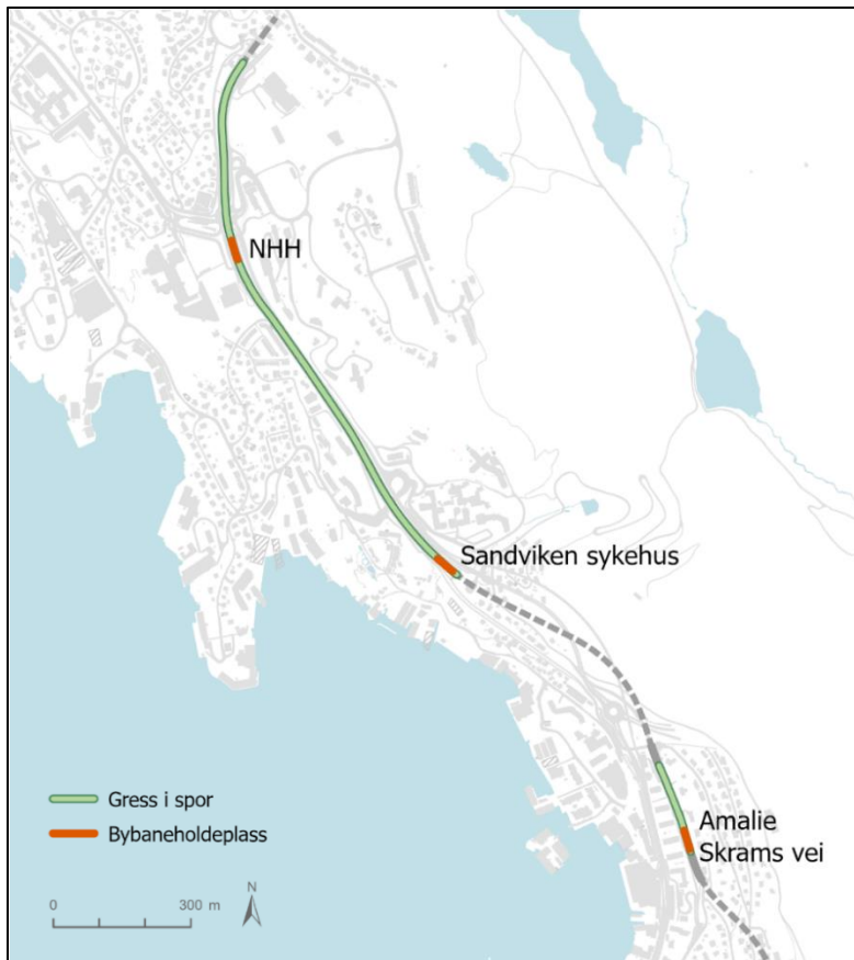
Figur 6-6: Deler av bybanetraseen som skal opparbeides med gress i spor (markert med grønn linje).
